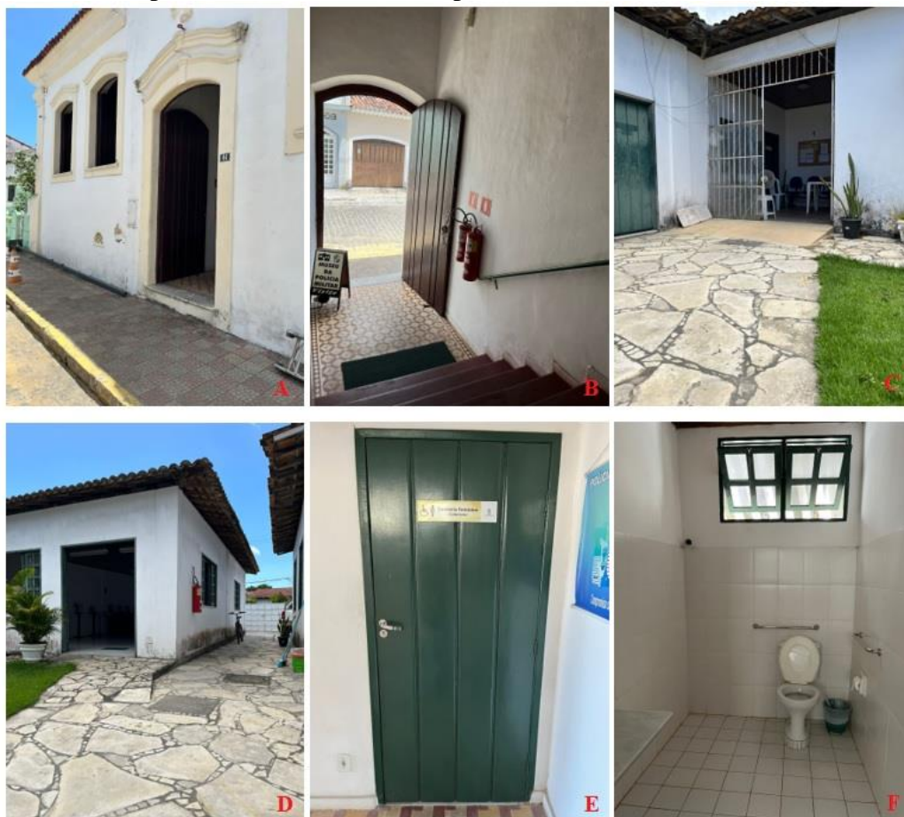
Figura 18 – São Cristóvão/SE: Questões de acessibilidade no Museu Militar de Sergipe (A) Degrau na porta; (B) Escada com corrimão; (C) Rampa de acesso em madeira; (D) Rampa de acesso em pedra calcária; (E) SIA na porta do banheiro; (F) Banheiro acessível
